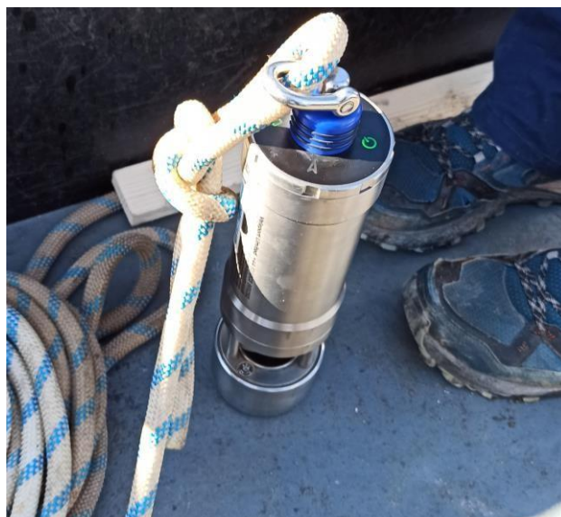
Figura 8: Montaje del SVP en la embarcación para realizar el perfil de velocidades.
