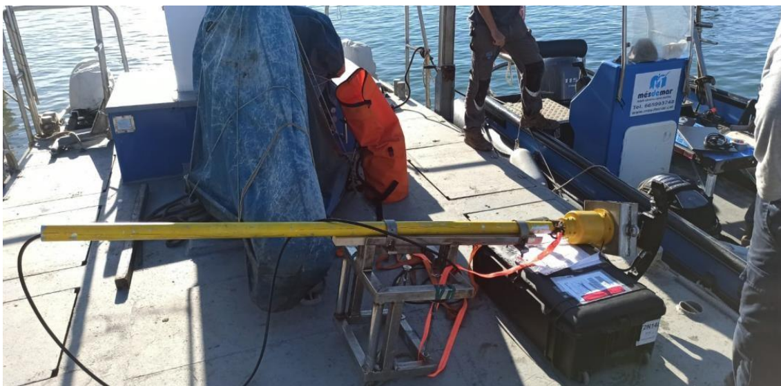
Figura 4: Montaje de la cabeza de la ecosonda multihaz e IMU.
