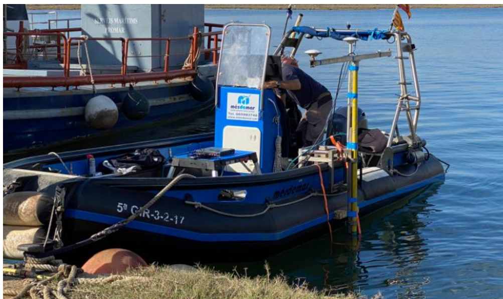
Figura 5 Montaje de la MBES en la embarcación.
